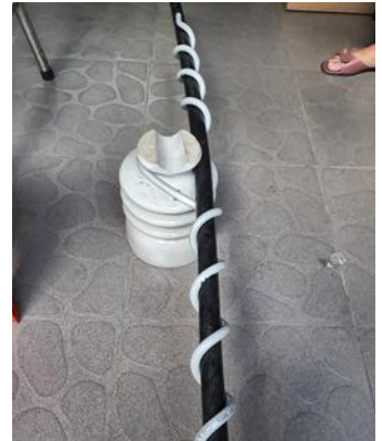
Top tie on pin insulator ខ្សែចងក្បាលស៊ុយ
